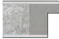
Türblatt Kleine Rundkante (KR) ca. 2,8 mm Radius
