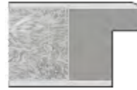
Türblatt Rund-Postformingkante (RP) ca. 5,5 mm Radius
