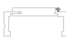
Futter Hohlkehle (HK), Bekleidungsbreite 65 mm
