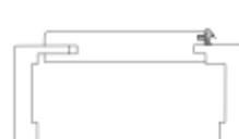
Futter kleine Rundkante (KR), Bekleidungsbreite 80 mm
